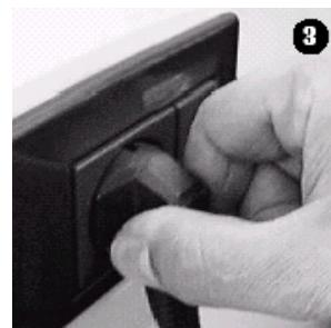
Durante las operaciones de mantenimiento y limpieza, o en caso de funcionamiento defectuoso, desconecte el aparato de la red, extrayendo el enchufe de la toma de alimentación (tirando del enchufe y no del cable) (figs.2 y 3).
